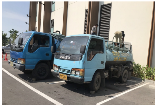
ภาพที่ 3-7 รถสูบน้ำตะกอน
